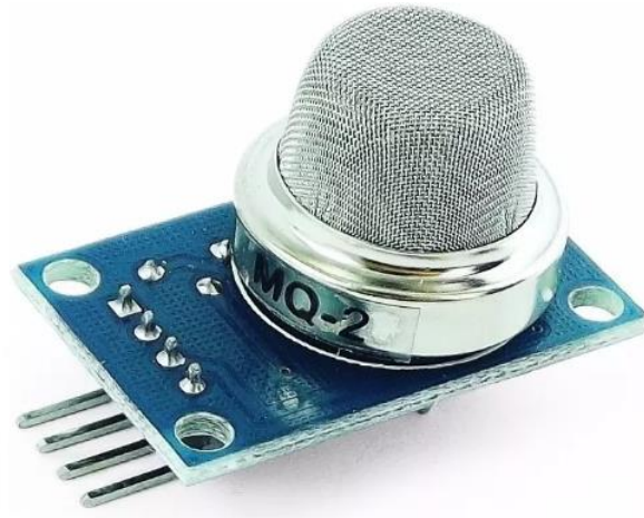
Figura 4. Sensor de Gas Aire Mq2.
