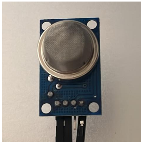
Figura 8. Sensor de Aire Gas MQ2 Frontal
