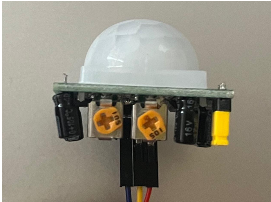
Figura 10. Sensor Infrarrojo De Movimiento Hc-sr501.
