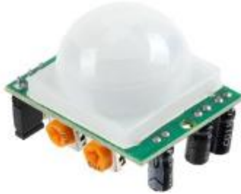
Figura 5. Sensor Infrarrojo de Movimiento Hc-sr501.
