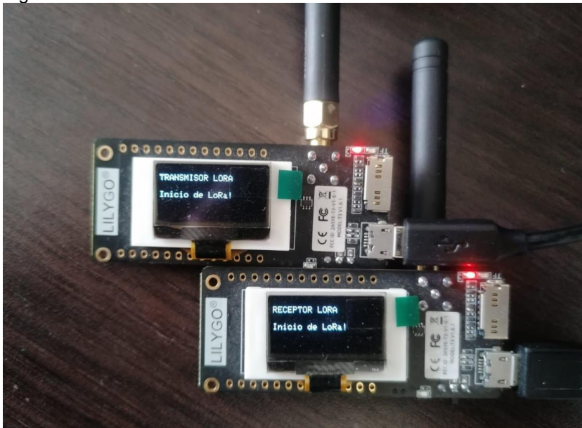
Figura 6. Comunicación inicial radios LoRa.
