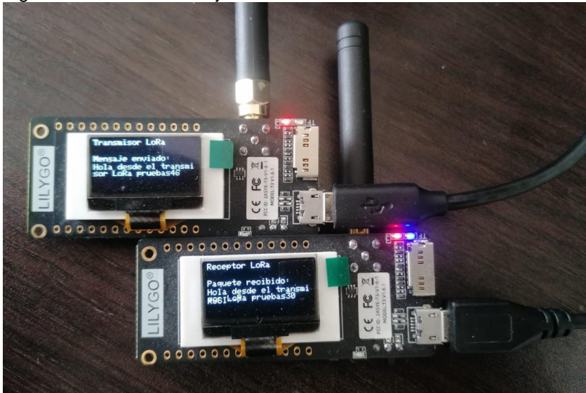
Figura 7. Envío de mensajes entre radios LoRa.
