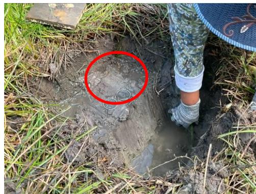
b) Se observa borde superior de cilindros en la superficie de suelo.
