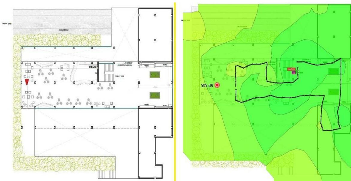
Con la utilización de la herramienta Ekahau HeatMapper, se construyen los mapas de calor que especifican las áreas de cobertura que brinda la solución WiFi instalada. Las pruebas son tomadas con la carga del plano de las
