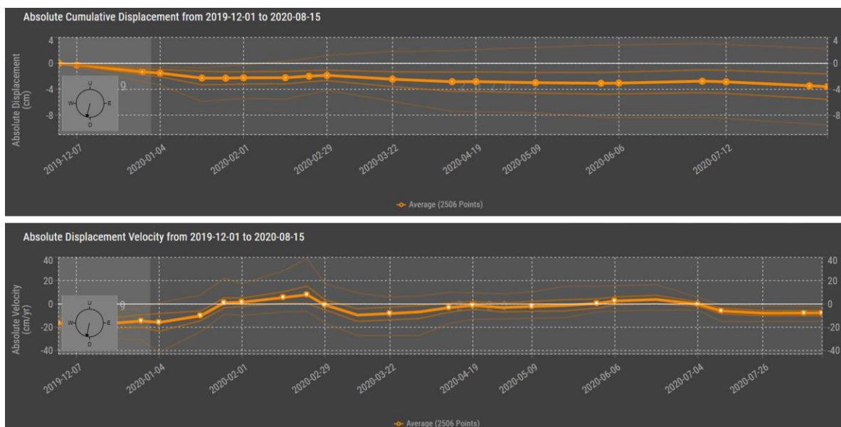
Figura 11. Gráficas de desplazamiento y velocidad absoluta en la presa para el periodo 2019/12/01-2020/08/15.
