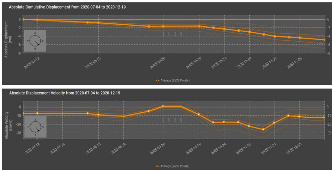
Figura 14. Gráficas de desplazamiento y velocidad absoluta en la presa para el 2020/07/04-2020/12/19.
