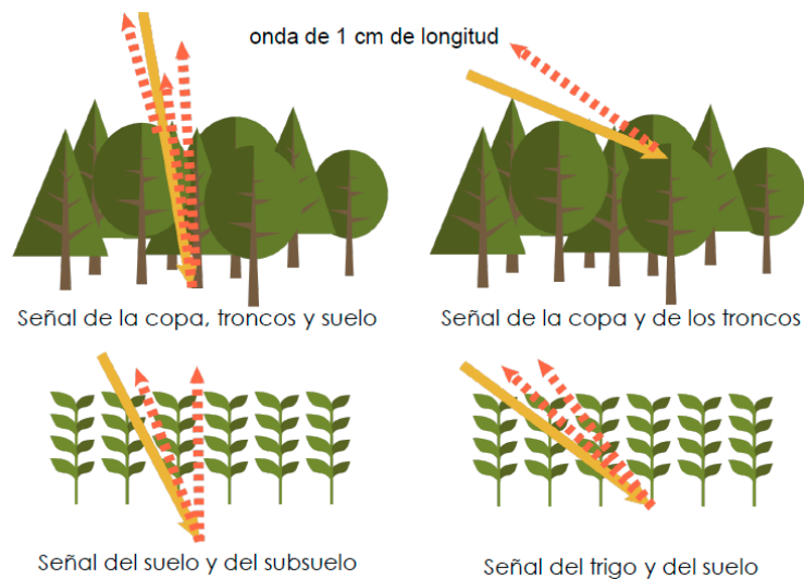
Figura 8. Efectos del ángulo de incidencia sobre las cubiertas iluminadas por un pulso SAR
