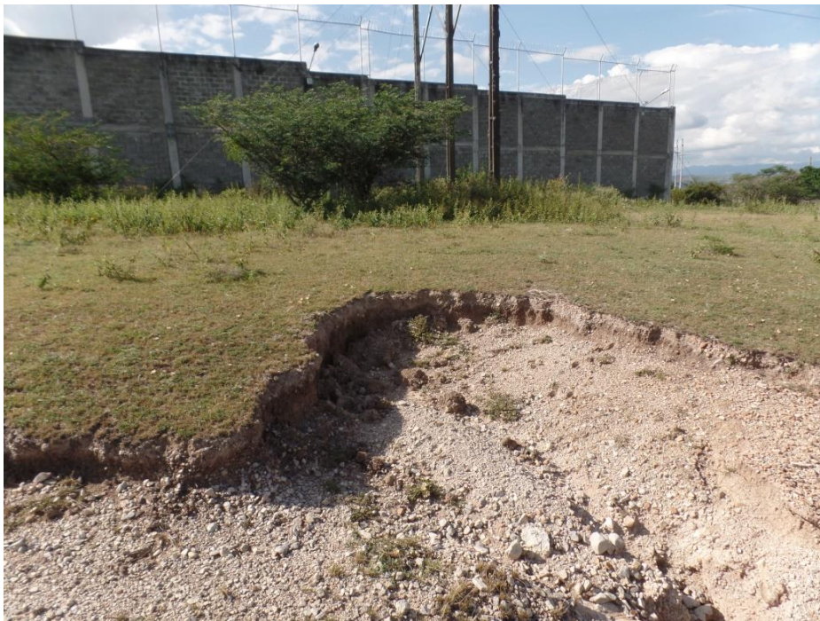
IMAGEN 14. CARCAVAMIENTOS DE MÁS DE 1 METRO DE ANCHO, CON CORONA AGUDA, INDICA UN GRADO MUY ALTO DE EROSIÓN. CRÍTICO PARA CUALQUIER OBRA DE INFRAESTRUCTURA CERCANA. EN ESTE CASO, LA SUBESTACIÓN
