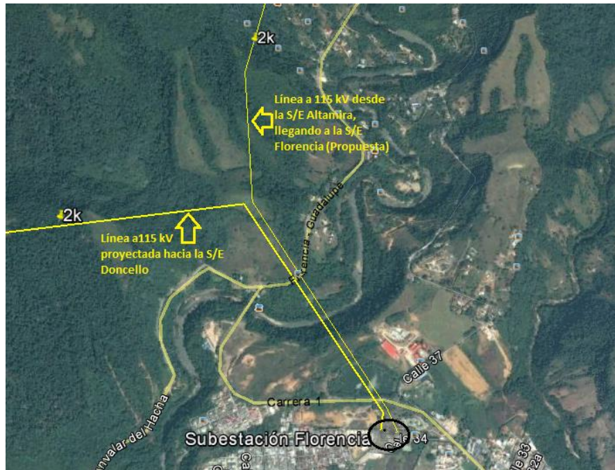
Imagen 22. Direccionamiento de la línea a 115 kV propuesta llegando a la S/E Florencia y saliendo hacia la S/E Doncello
