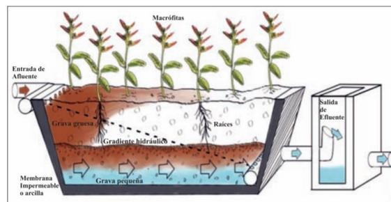
**Figura 2.** Elementos de un humedal artificial con flujo subsuperficial. **Fuente:** (Dolores et al., 2018)
