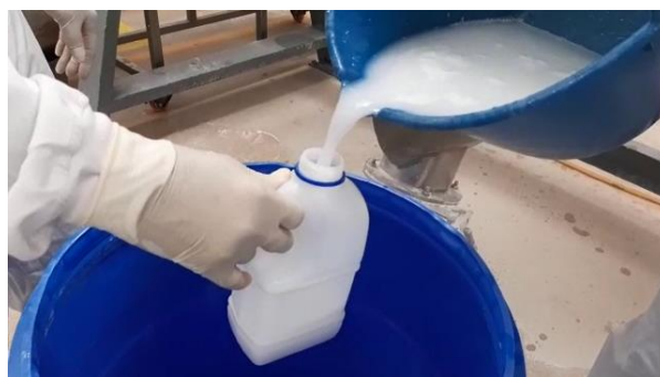
Figura 4 Toma de muestra de las aguas residuales del proceso de fabricación de la Azitromicina 500 mg Tab.
