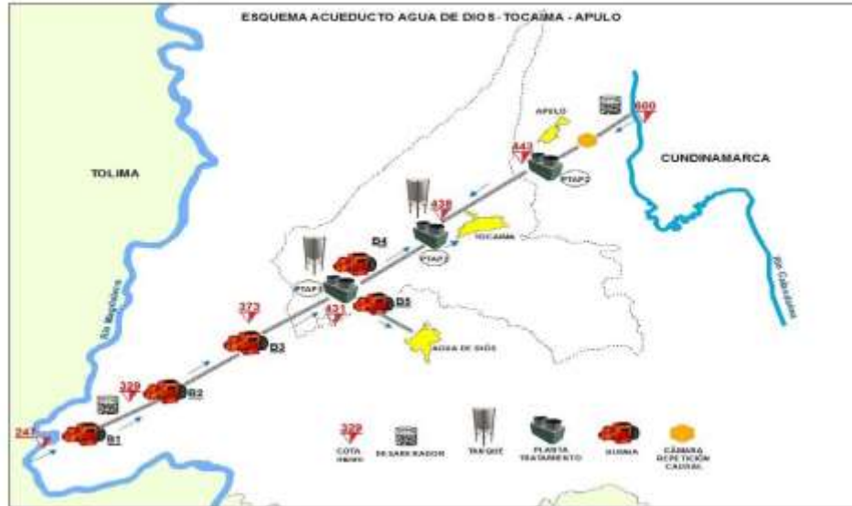
Figura 14 Esquema sistema de acueducto regional, Agua de Dios – Tocaima - Apulo
