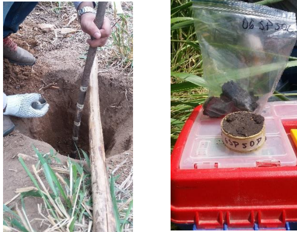
Figura 4. Minicalicata para la muestra de suelo para determinación de densidad aparente y Carbono Orgánico COS.
