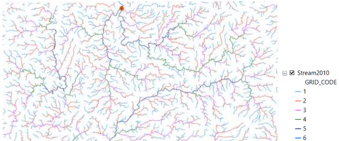
Figura 17. Conversión de la red de drenaje a vectorial con la herramienta stream to feature
