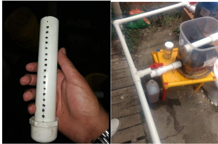
Imagen No. 21 sistema de distribución uniforme
