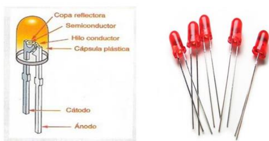
Ilustración 16. Diodo emisor de luz
