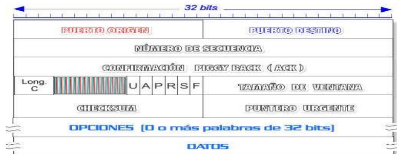
Figura 18. Formato de los segmentos TCP
