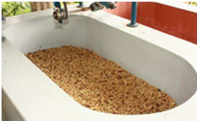
Figura 3. Tanque Tina abierto con grano despulpado (Fuente: Cenicafé. Disciplina de Poscosecha. Copyright 2016).
