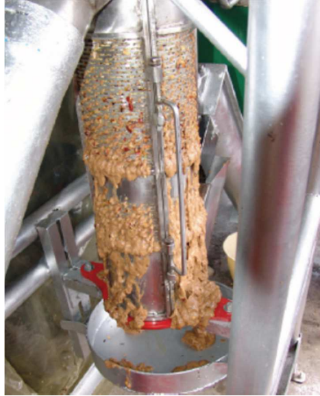
Figura 4. Desmucilaginador mecánico. (Fuente: Cenicafé. Disciplina de Poscosecha. Copyright 2016)
