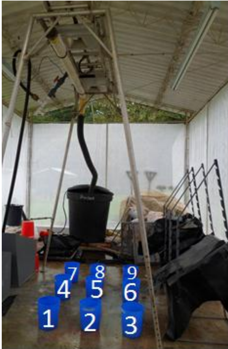
Figura 4. Calibración de simulador de lluvia.
