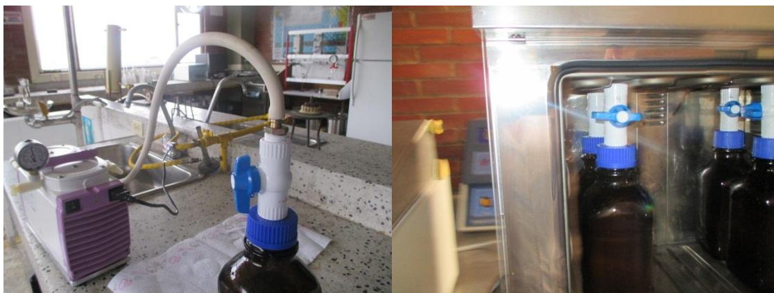
Figura 35. Sellado Biodigestores. Autor
