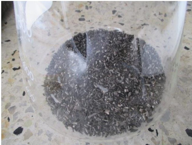
Figura 27. Purificador de H_2S (limadura de hierro 100 gr). Autor
