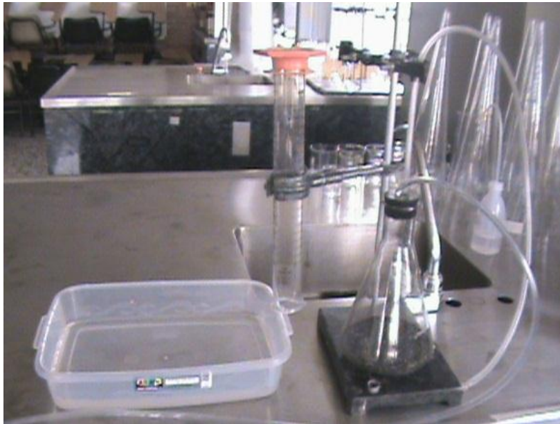
Figura 28. Purificador de CO 2 (Solución de hidróxido de sodio 10%). Autor
