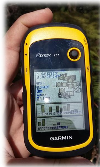
Figura 9. Trabajo en campo con GPS Garmin Etrex 10 Fuente: Elaboración propia.
