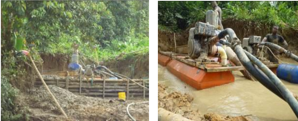
Imagen 4. Entable minero a la orilla del río Cabí, método de extracción con motobomba
