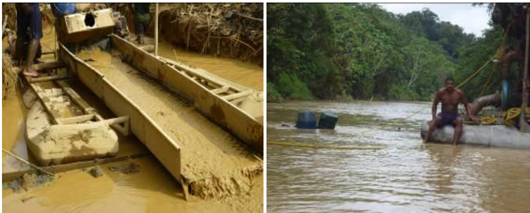
Imagen 5. Clasificadora de mineral artesanal y buzo de draga
