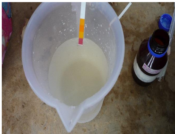
Foto 14. Ajuste de pH para el envío de las muestras con H 2 SO 4 concentrado.
