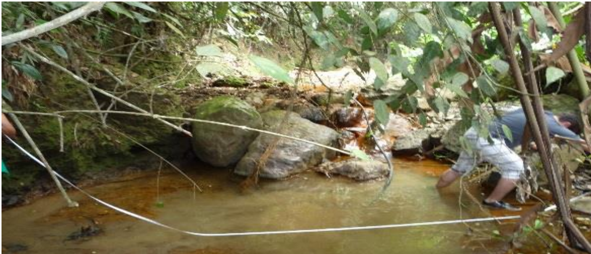
Foto 12. Medición del ancho para determinar el caudal, estación de muestreo 2.
