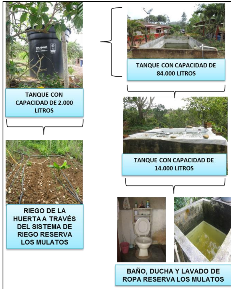
Figura 5: otros usos del agua y distribución del agua lluvia captada.
