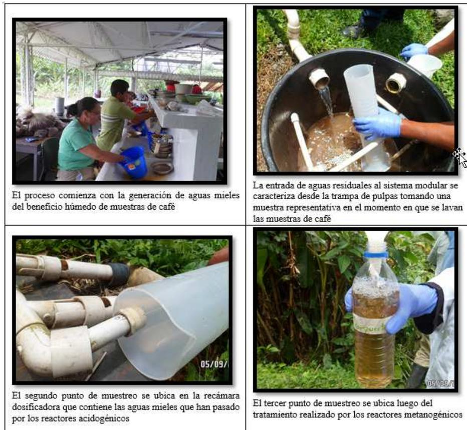
**Figura 7.** Toma de muestras de aguas residuales del beneficio de café para la caracterización fisicoquímica en el sistema modular de tratamiento.
