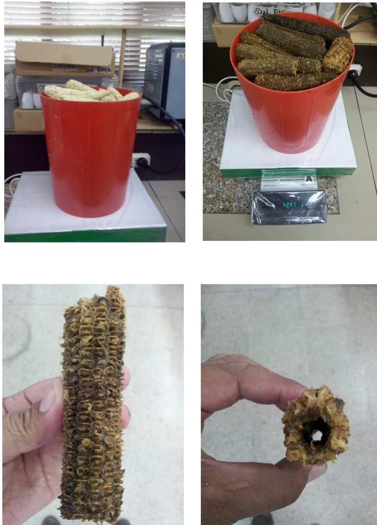
**Figura 5.** Determinación del peso seco y húmedo de las tusas de maíz
