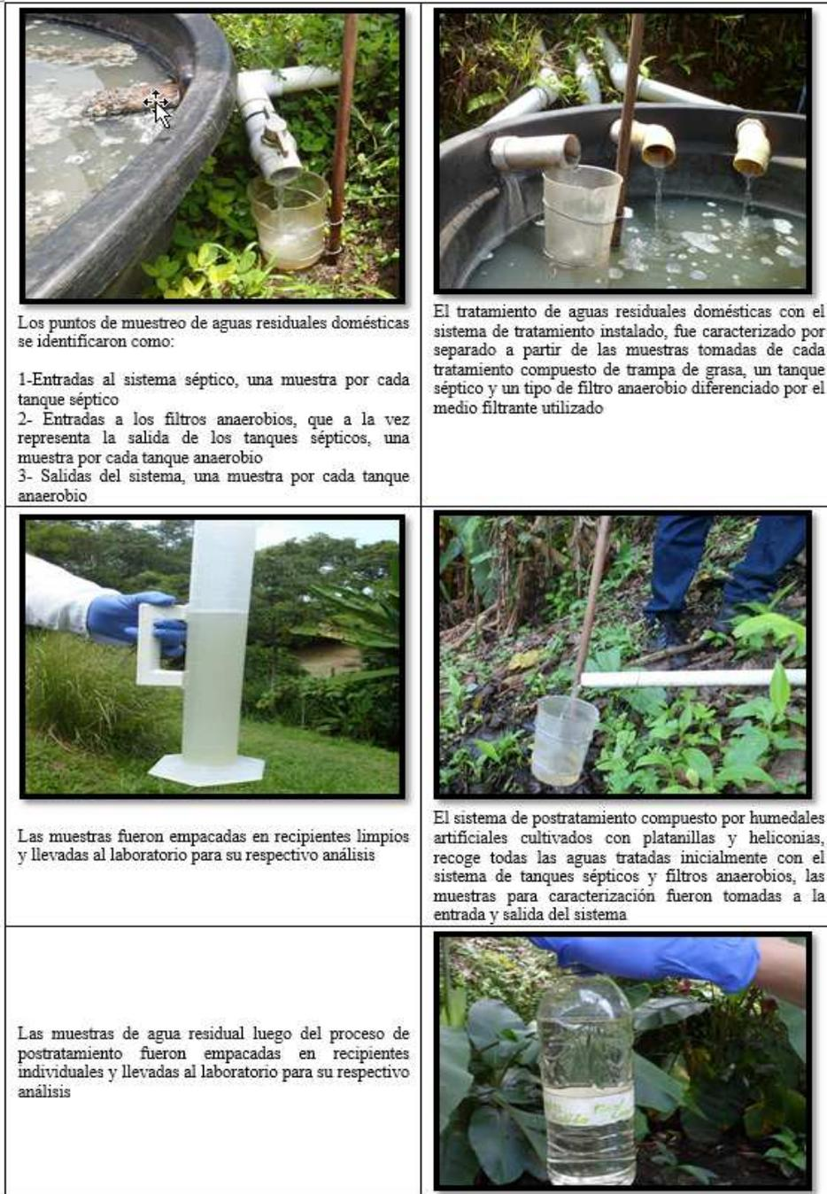
**Figura 6.** Toma de muestras de aguas residuales domésticas para la caracterización fisicoquímica y microbiológica a la entrada y salida del sistema séptico.
