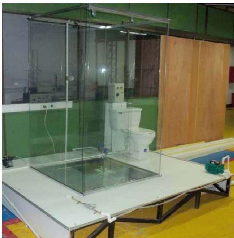
Figura 16. Vista prototipo reciclador de aguas grises construido por estudiantes de la F.U. Los Libertadores. Datos suministrados por (Díaz, Pérez, Rodríguez, 2012)
