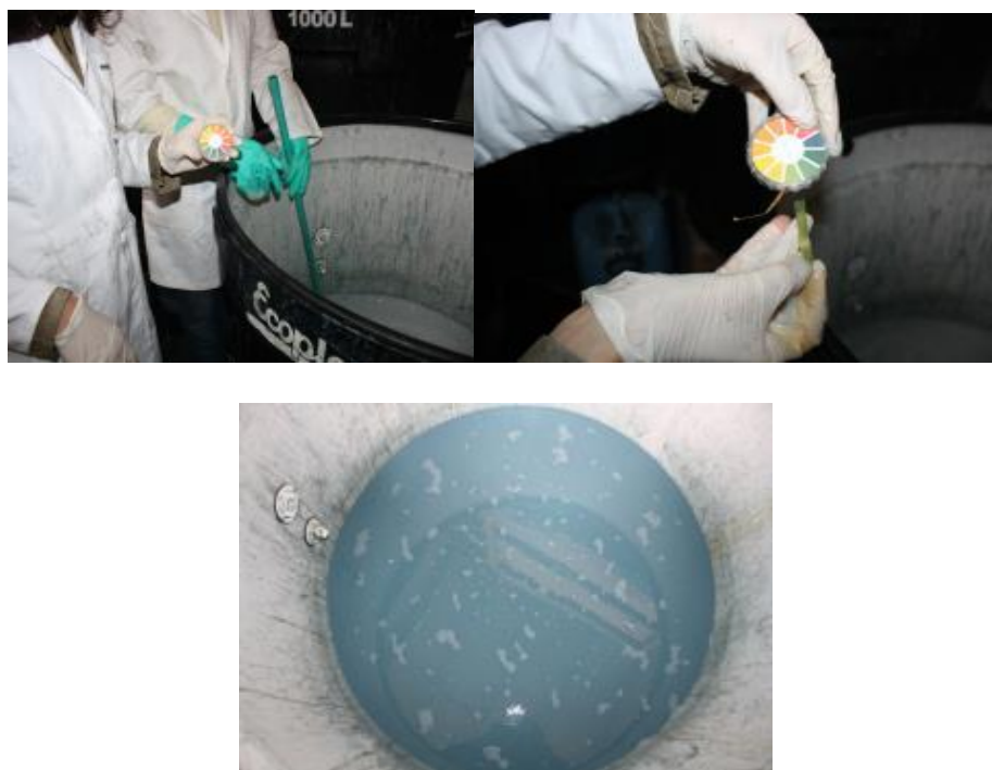
Figura 14. Adición de soda cáustica al agua residual de curtido filtrada hasta pH 9, en la planta
