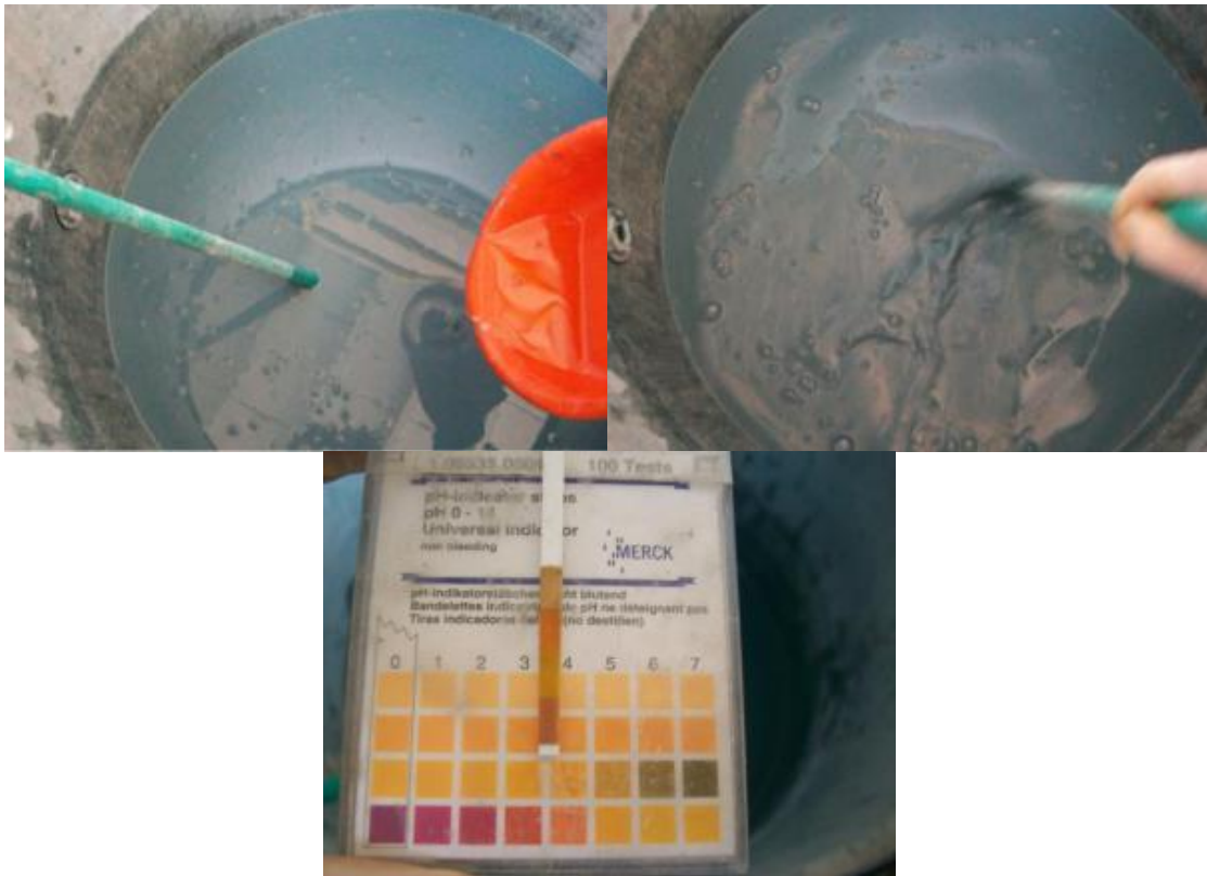
Figura 19. Curtido de pieles con mezcla de sal de cromo regenerada y sal de cromo comercial
