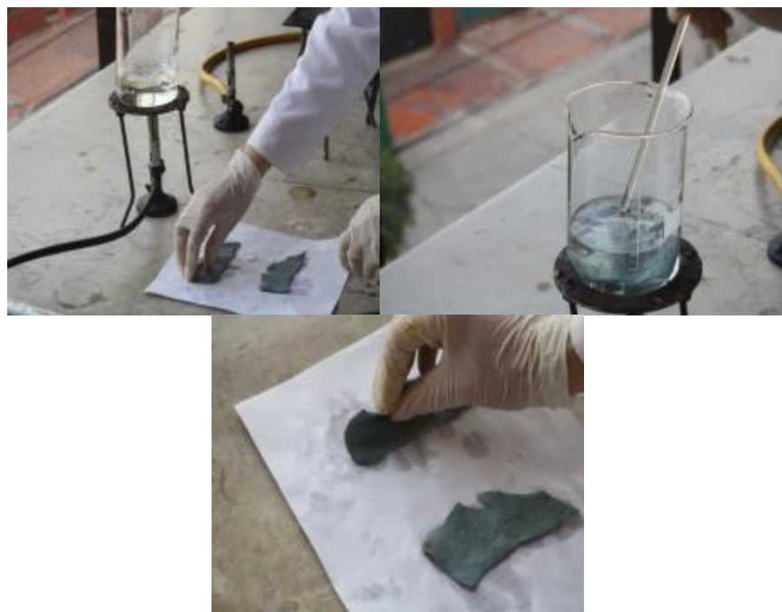
Figura 104. Prueba de encogimiento del cuero después de curtido con la mezcla sal regenerada y sal de cromo comercial
