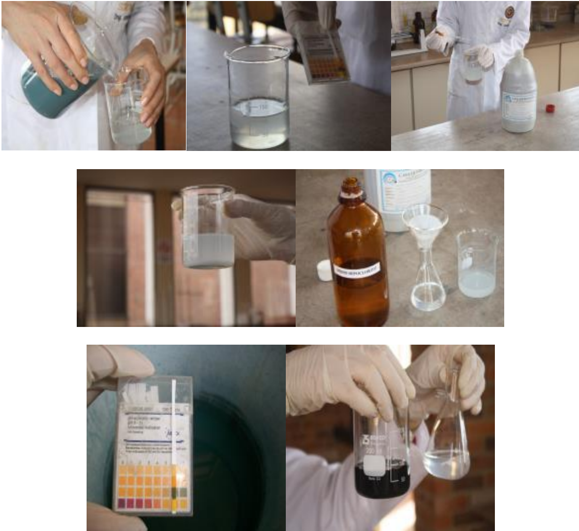
Figura 17. Separación del agua sobrenadante y tratamiento con policloruro de aluminio y cloro
