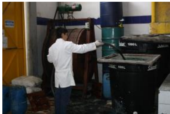
Figura 12. Filtración en la planta del agua residual del proceso de curtido
