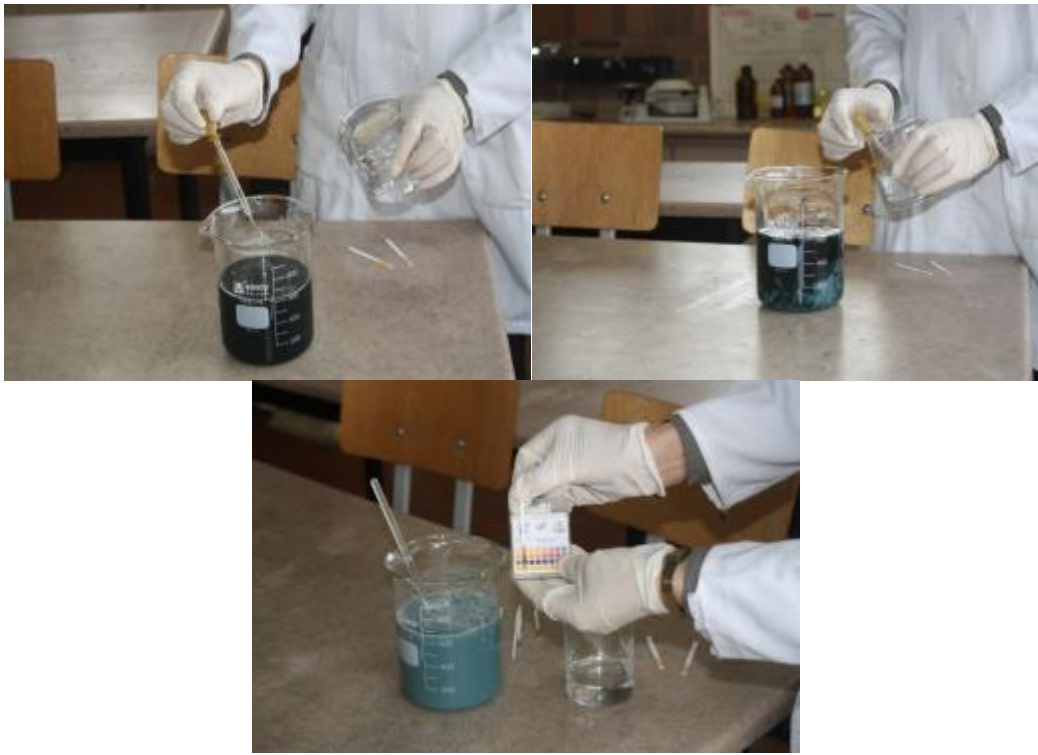
Figura 14. Adición de soda cáustica al agua residual de curtido filtrada hasta pH 9, en la planta
