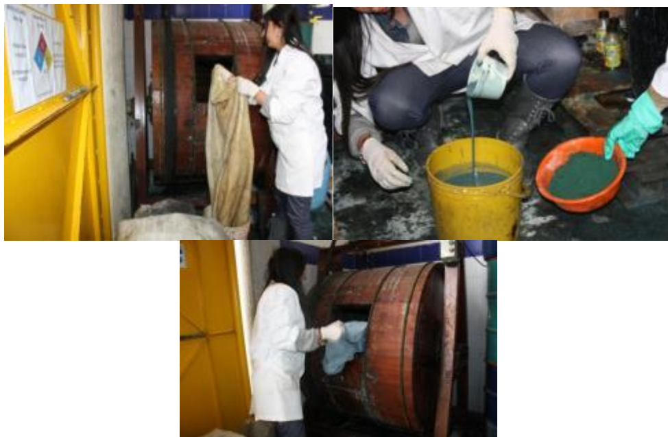
Figura 19. Curtido de pieles con mezcla de sal de cromo regenerada y sal de cromo comercial
