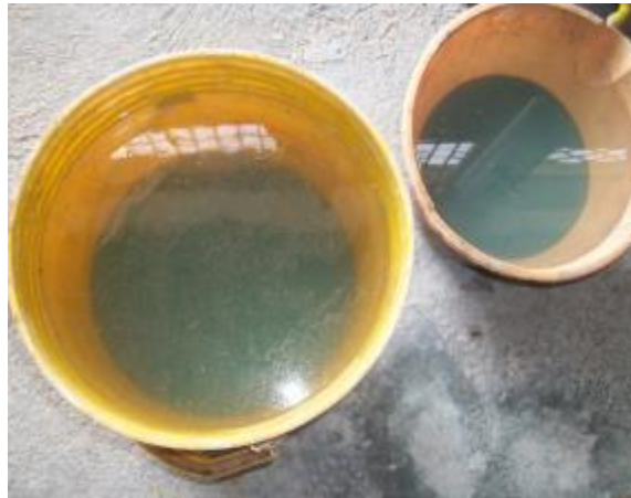
Figura 16. Precipitado de hidróxido de cromo y agua sobrenadante del agua residual del proceso de curtido en planta
