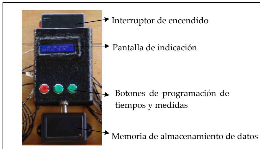
Figura 11. Medición de temperatura en la masa de café
