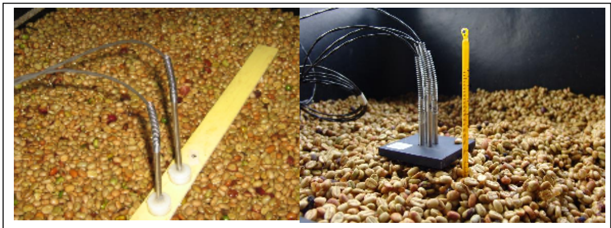
Figura 11. Medición de temperatura en la masa de café
