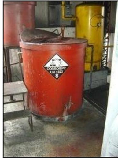
Imagen 54. Recipiente para la preparación de NaOH
