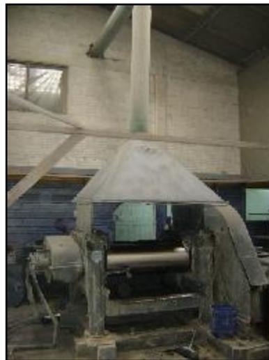
**Imagen 45. Molino para homogenización**
