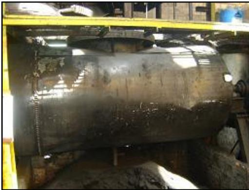
**Imagen 39. Autoclave para regenerado**
