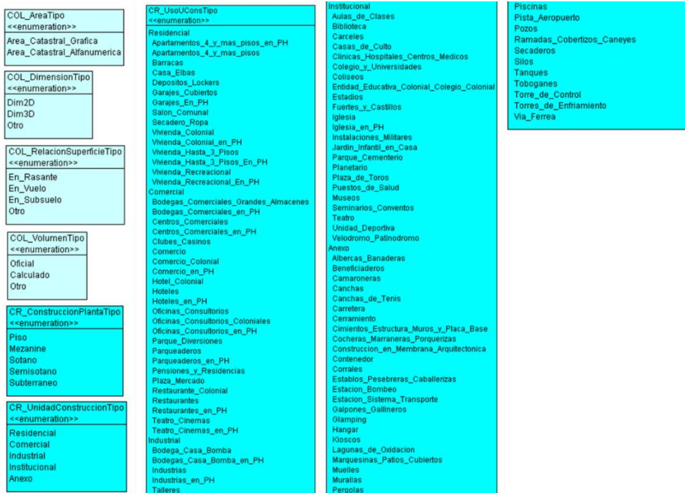
Diagrama 14. Dominios asociados al Paquete de Unidad Espacial, del Modelo Extendido Catastro Registró LADM_COL V.4.
