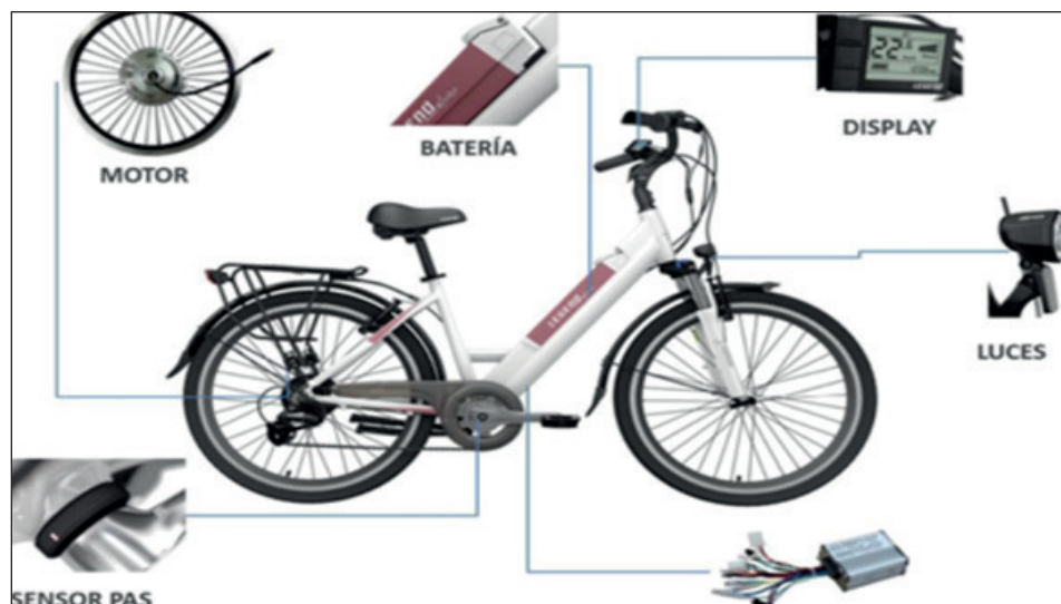
Figura 14.2. Componentes eléctricos y electrónicos de una bicicleta eléctrica (Veliz, 2018, 17)
