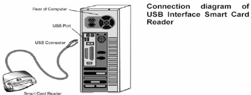
Figura 1. Conexión del lector/escritor acr30u
