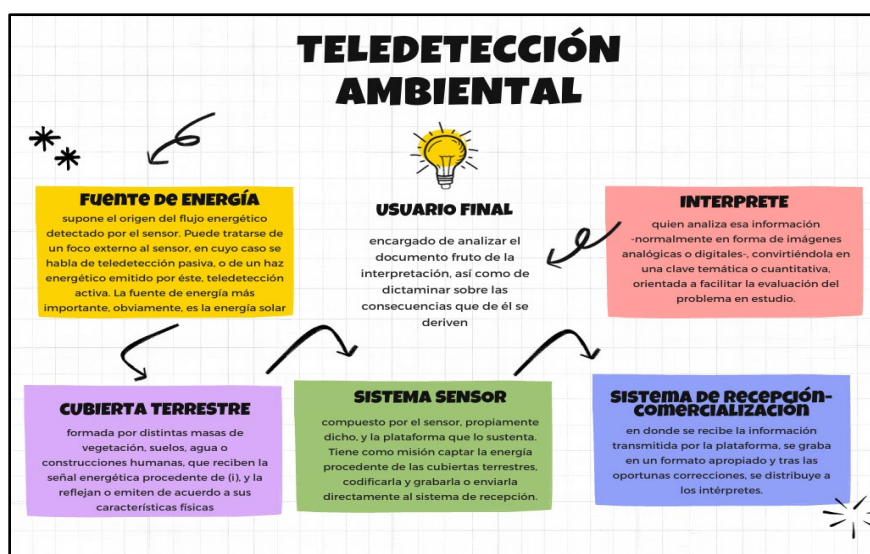
Ilustración 1. Elementos de teledetección ambiental, elaboración propia Fuente: Chuvieco (1995)
