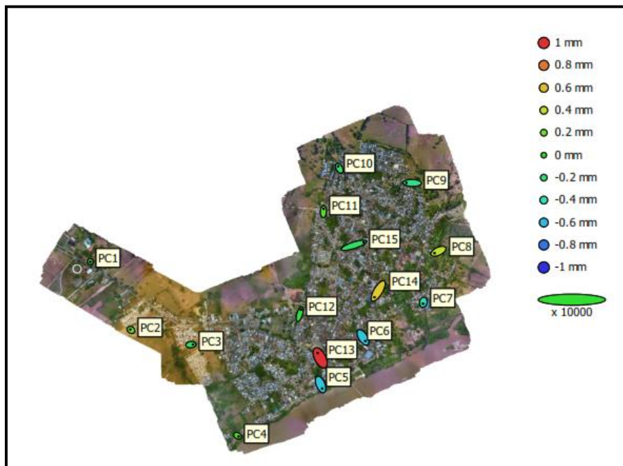
Ilustración 6 Ajuste de puntos de control
