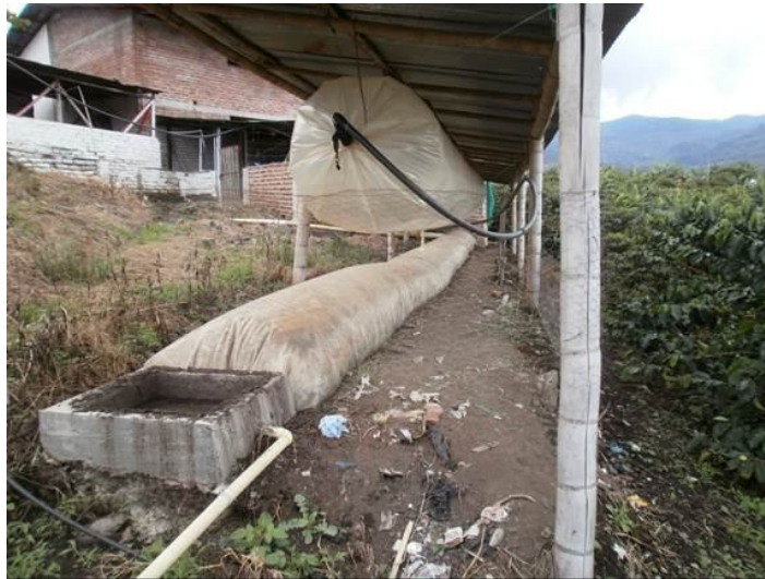
Figura 7. Biodigestor tipo tubular plástico.
