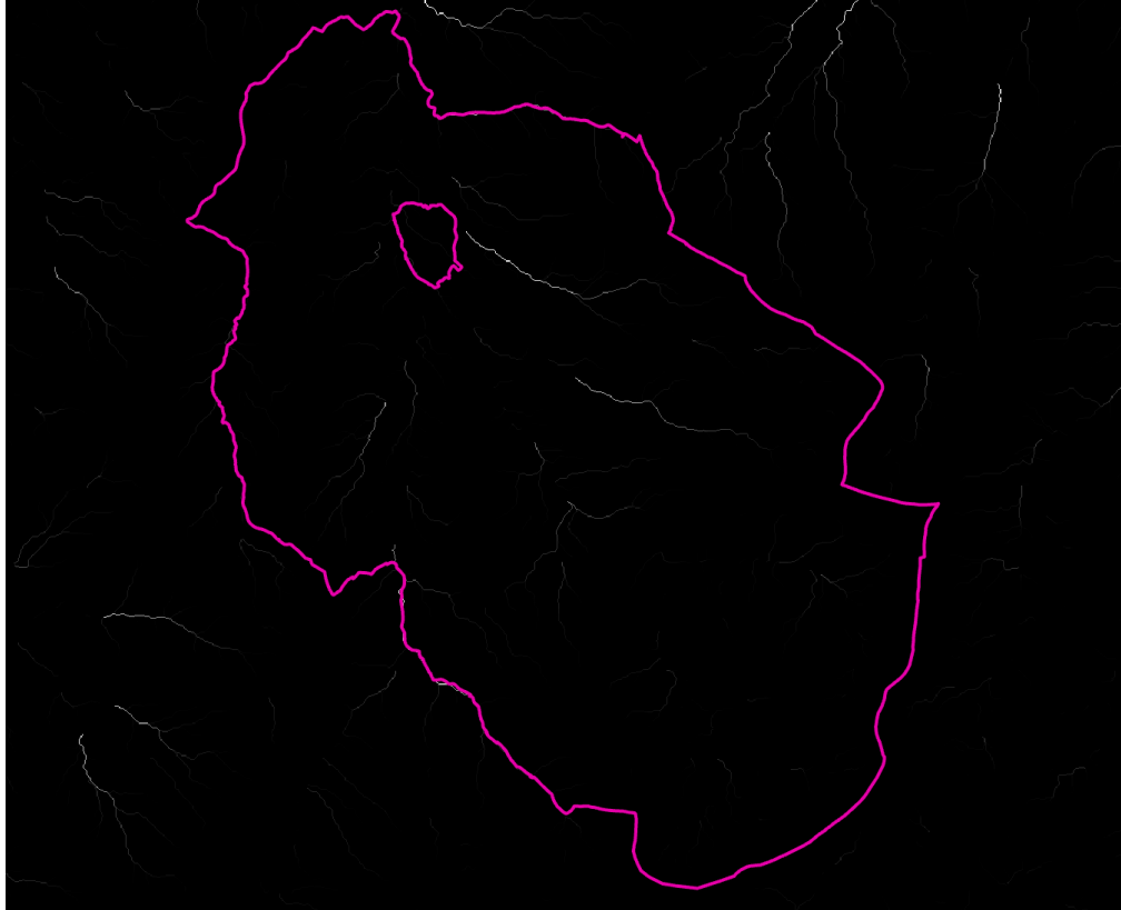
Ilustración 16. Flow accumulation – Arcgis Pro
