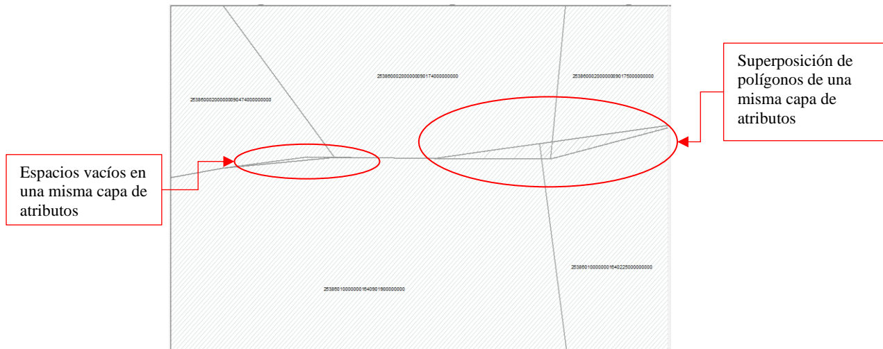
Ilustración 1. Error topológico presentado en la capa de Terreno
