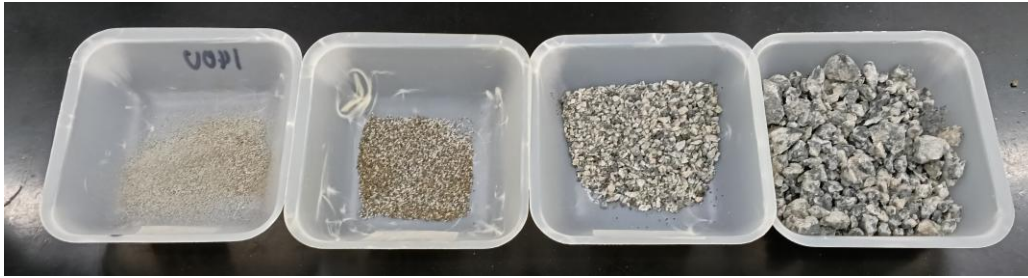
Figura 1. Apariencia del material en las diferentes granulometrías preparadas para el montaje del ensayo.
