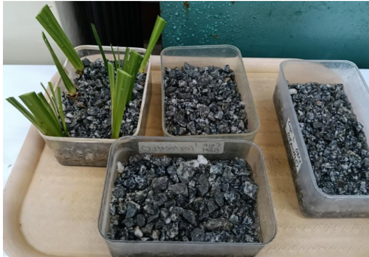
Figura 3. Montaje establecido para la determinación de la depuración de metales pesados.
