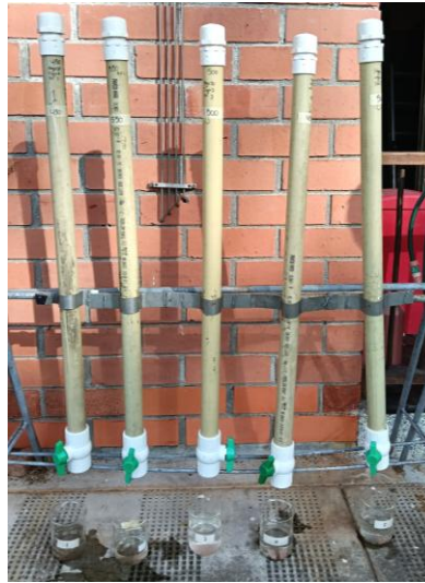
Figura 2. Montaje establecido para la evaluación de la capacidad de neutralización de la roca.
