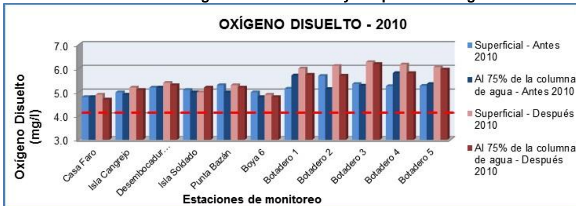
Gráfica 4-30 Niveles de Oxígeno Disuelto Antes y Después del dragado - Año 2010
