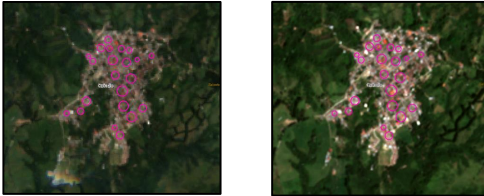
Figura 18: Semillas implementadas en la identificación de la clase “tejido urbano”. Imagen Mosaico (Izquierda) e Imagen S2A 2020 (Derecha), combinación en color real (B4+B3+B2). Fuente: Elaboración propia a partir de productos ArcGIS.
