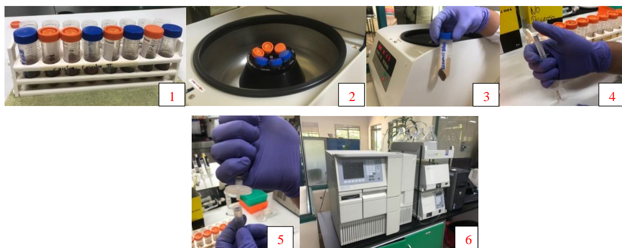
Figura 4. Muestreo, procesamiento y cuantificación de ácidos orgánicos acético, cítrico y láctico de los dos sustratos de aguas residuales del café mediante cromatografía líquida HPLC (Foto 1. Submuestras de 25 mL de cada sustrato; Foto 2. Centrifugación; Foto 3. Separación de sobrenadantes; Foto 4. Filtrado; Foto 5. Deposición de muestras; Foto 6. Análisis de muestras en HPLC).
