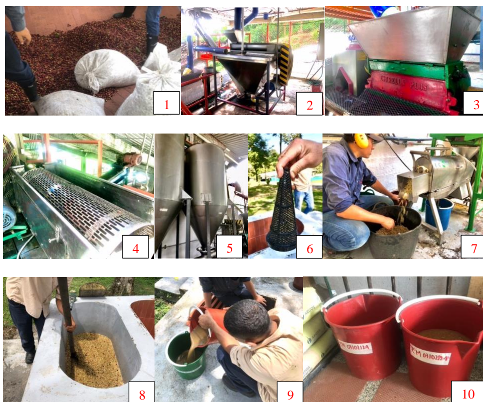
Figura 1. Prácticas del beneficio del café y toma de muestras de aguas residuales del lavado (Foto 1. Recibo del café cereza en tolva; Foto 2. Clasificación de cerezas por densidad en separador hidráulico; Foto 3. Despulpado; Foto 4. Clasificación por tamaño del pergamino en baba en zaranda perforada; Foto 5. Fermentación del pergamino en baba en tanque; Foto 6. Determinación de punto de lavado con Fermaestro®; Foto 7. Lavado y colecta de mieles del Ecomill® LH 300; Foto 8. Lavado por agitación en Tanque tina®; Foto 9. Colecta de aguas de primera cabeza de lavado del Tanque Tina®. Determinación de pH; Foto 10. Inicio de fermentación aeróbica de las aguas residuales del lavado del café).
