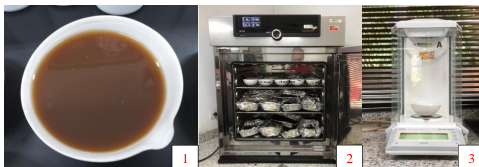
Figura 2. Muestreo, pesaje inicial, secado mecánico y pesaje final de sólidos totales de los dos sustratos de aguas residuales del lavado del café (Foto 1. Montaje de muestras en cápsulas de porcelana de 100 mL; Foto 2. Secado de muestras; Foto 3. Pesaje en balanza electrónica).
