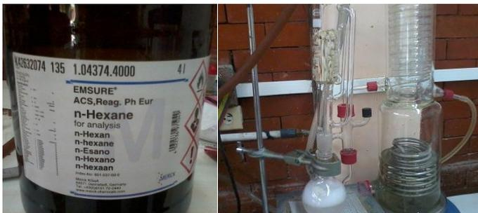
Figura 6. Solvente y montaje soxhlet. Fuente: Autor.
