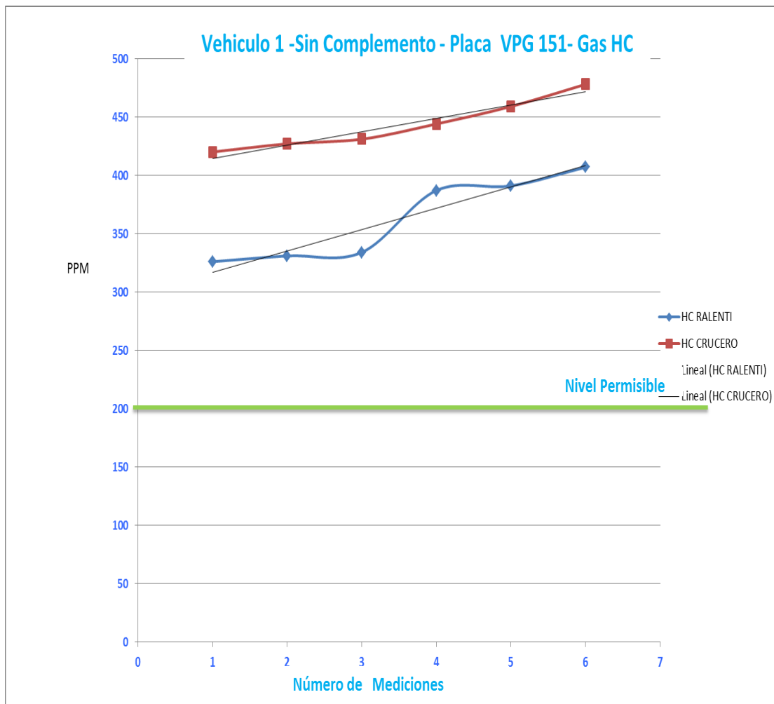
Figura 25. Mediciones del vehículo 1, sin complemento – Gas HC. Autores
