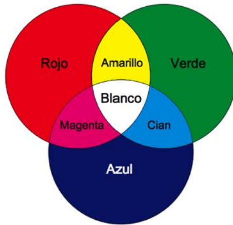
Ilustración 5. Procesos de formación del color (Aditivo) – Colores primarios.
