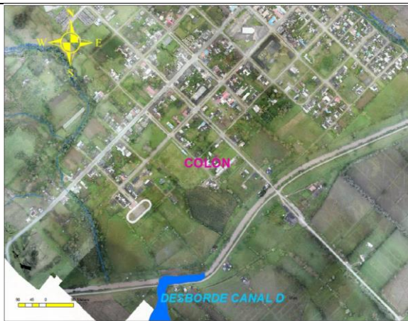
Fotografía 3. Ortofoto tomada con dron para localización de la ruptura del dique canal D en el Municipio de Colón.
