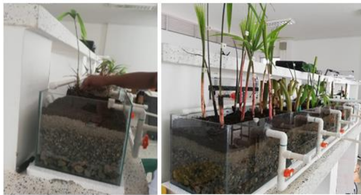
Figura 1. Plantación y desarrollo de las especies vegetales en los humedales artificiales utilizados en el tratamiento de los lixiviados
