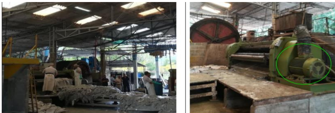
Imagen 1. Se visualiza al lado derecho descarnadora y motor descubierto. Al lado del motor se ubica un colaborador exponiéndose durante toda la jornada al ruido generado por el motor.
