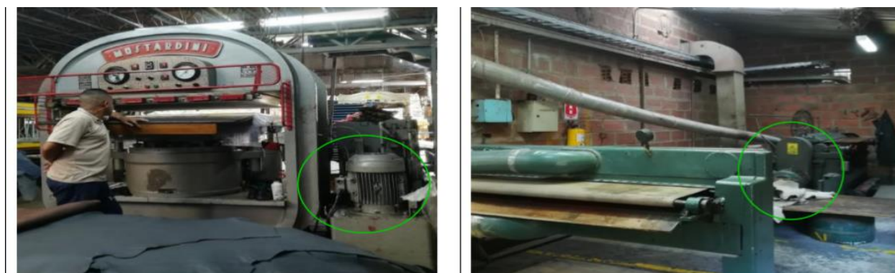
Imagen 2. El operario que labora en la prensa Mostardini, se encuentra ubicado como se observa en esta fotografía. Expuesto al ruido del motor de la máquina, el cual no tiene encerramiento. Adicional durante la muestra se percibe ruido que no es común de la operación, y se puede deber a un desgaste o daño del motor.
