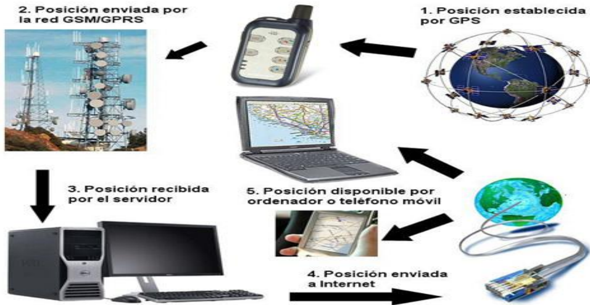
Figura 4. Cómo funciona el Sistema de posicionamiento global GPS
