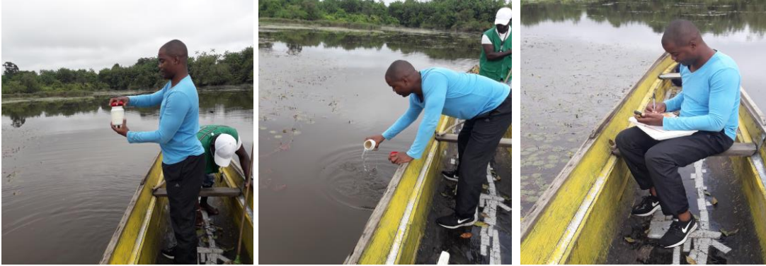
Figura 3. Toma de muestra y medición de variables físicas, químicas e hidrológicas, con el equipo digital multiparámetros.
