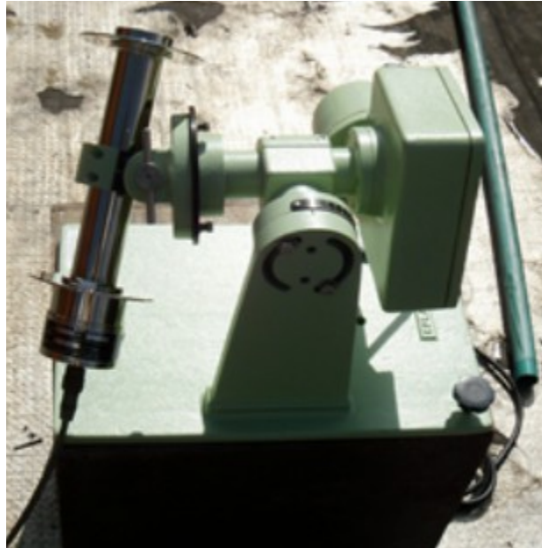
Figura 2. Pirheliómetro Eppley modelo NIP. Fuente. Autor
