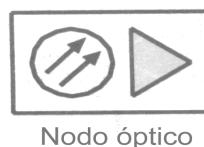
Figura 8. Símbolo utilizado en el diseño de redes de banda ancha para definir los nodos ópticos
