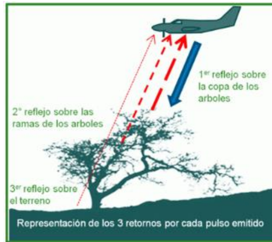
Figura 1. Comportamiento de un sistema LiDAR según la superficie
